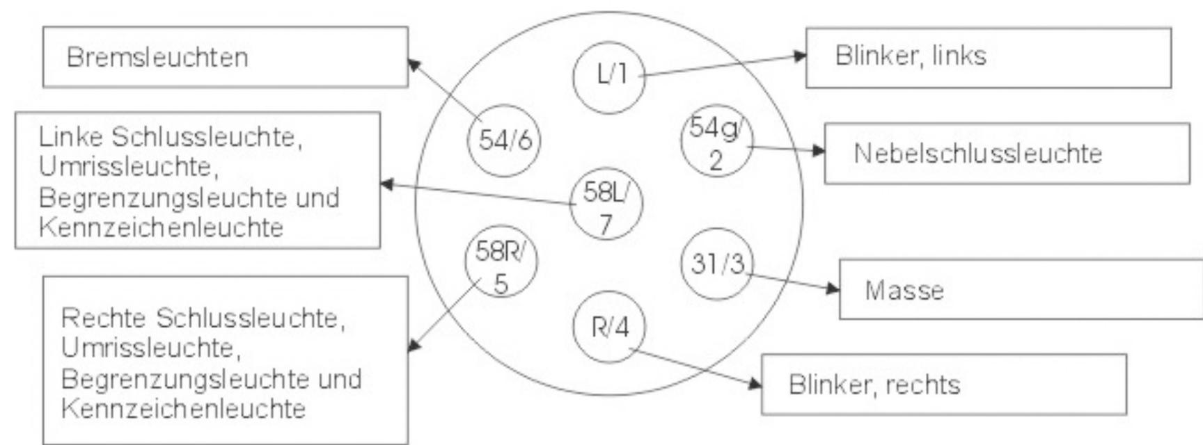
**Kontaktbelegung eines 13-poligen Anhängerstecker nach ISO 11446 (Ansicht auf die Steckkontakte der Buchse bzw. die Schraubkontakte des Steckers)**
